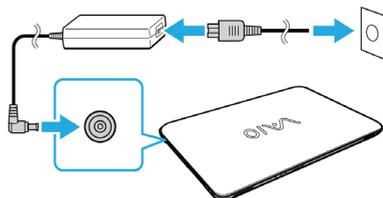
Conecte o cabo de alimentação ao adaptador CA. Depois conecte o cabo de alimentação CA a rede elétrica. Conecte o adaptador CA ao notebook.
