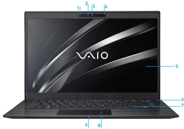
1. Microfone | 2. LED de status da câmera | 3. Câmera frontal | 4. Microfone | 5. Tela LCD\* | 6. Botão Liga/Desliga | 7. Teclado | 8. Touchpad | 9. Botões do Touchpad
